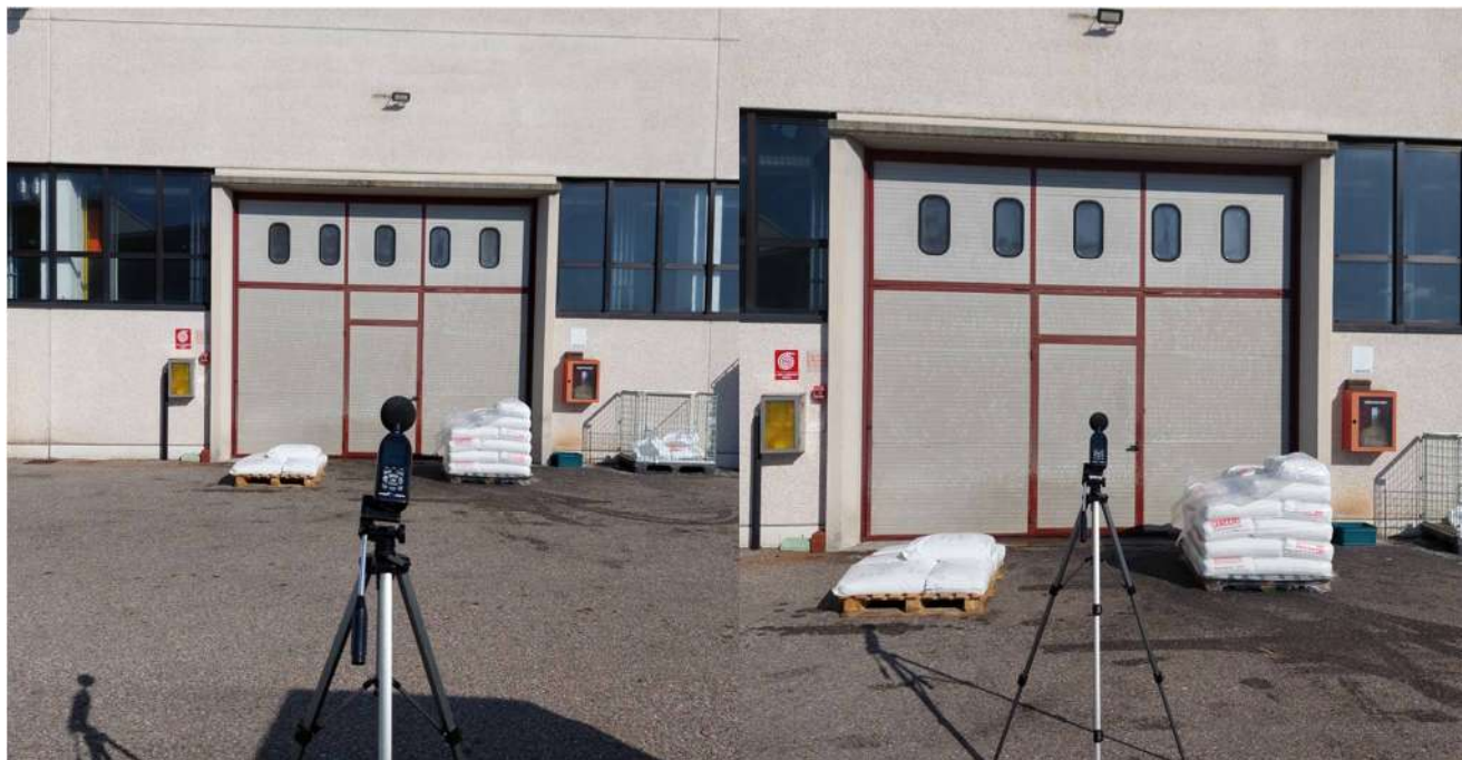
Figura 4.2.12, 4.2.13 – Immagini dei punti di misura P6-a (10 m) e P6-b (5 m) con portone chiuso
