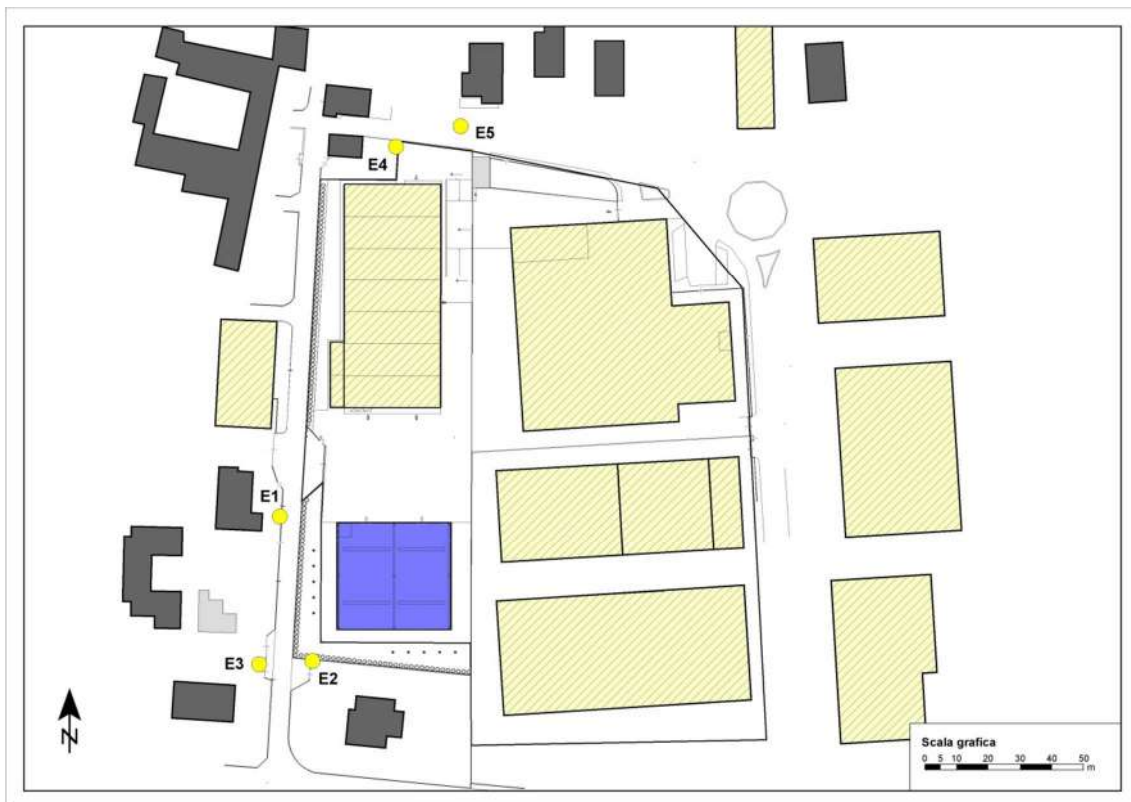
Figura 5.3.1 – Planimetria con i punti di verifica dei livelli di emissione ai ricettori
